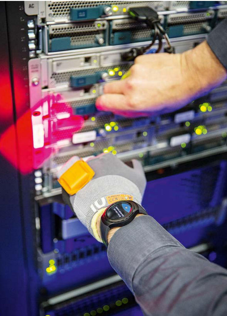
Fix ohne Handbuch. Im Innovation Center verproben Experten wie Wearables als Smart Watch, Sensorhandschuh, Scanner und AR-Brille Servicetechniker durch eine Reparatur führen.
