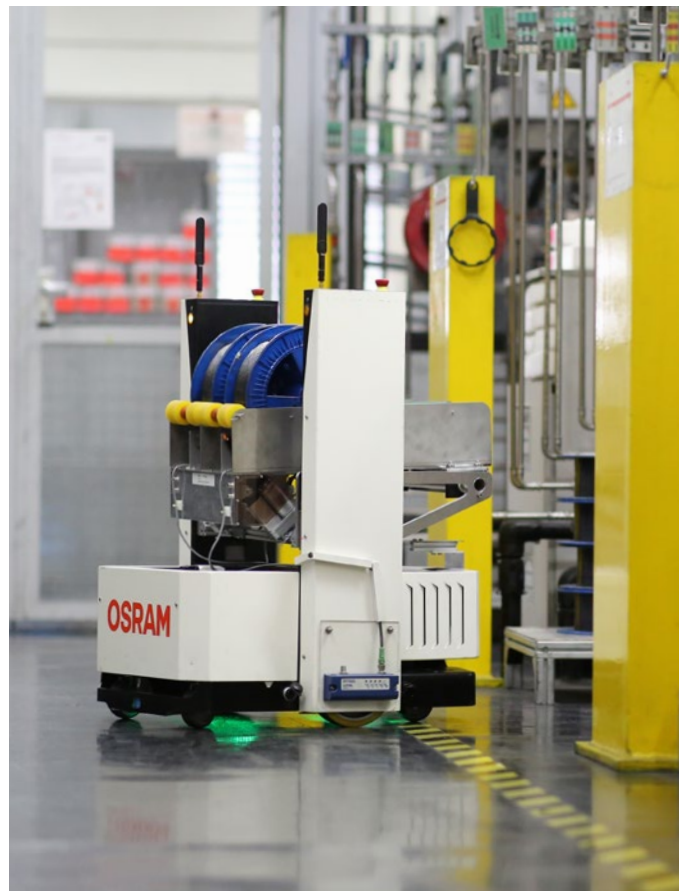
Der autonom fahrende Transportroboter „Efes“ transportiert Spulen mit Wolframfäden aus der Produktion in die Logistikhalle.
