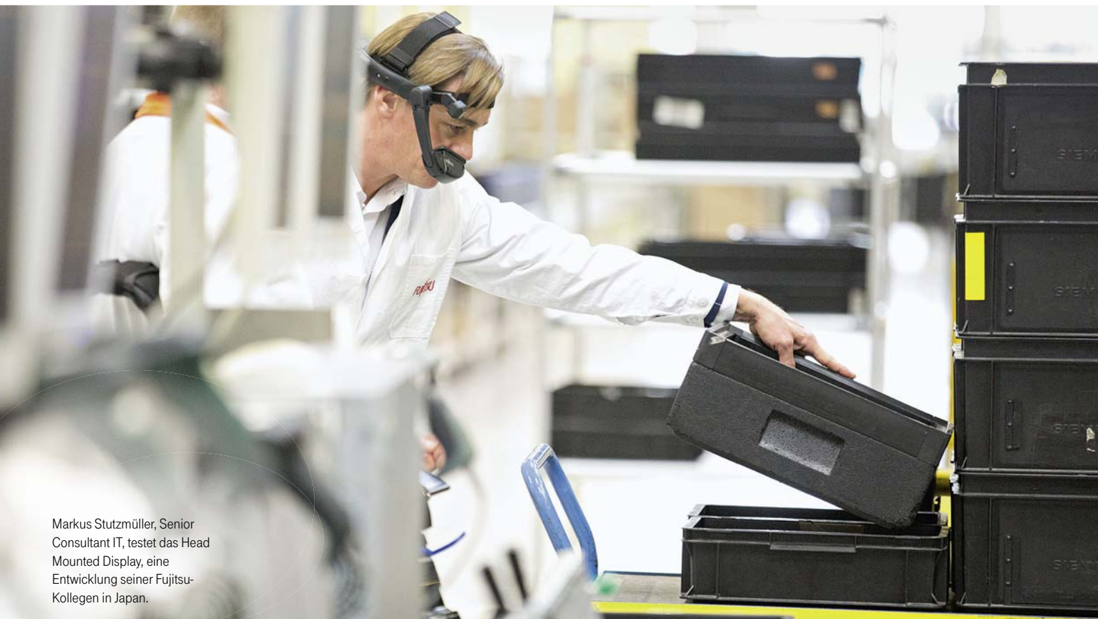
Der Headset-Monitor visualisiert unter anderem die Kameraeinstellungen, so, als würde der User einen Laptopbildschirm in 81 Zentimeter Entfernung betrachten.
